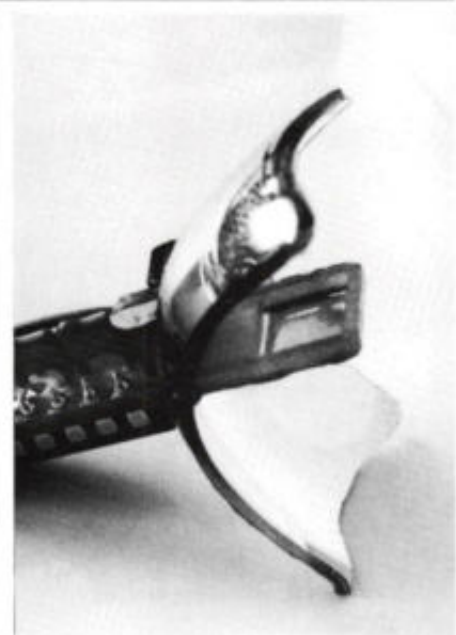
Afb. 1. Laboratorium-prototype van een door Siemens ontwikkelde pyro-elektrische sensor met parabolische spiegel. Deze sensor is gevoelig voor diep-infrarode warmtestraling en kan worden gebruikt voor personendetectie. Het eigenlijke sensorelement is een vliesdun laagje polyvinylidendifluoride dat spanningsvrij is opgehangen in een houder die tevens het elektrisch contact tot stand brengt. De fabrikant zal deze detector als complete in een behuizing gemonteerde transducent vervaardigen.
