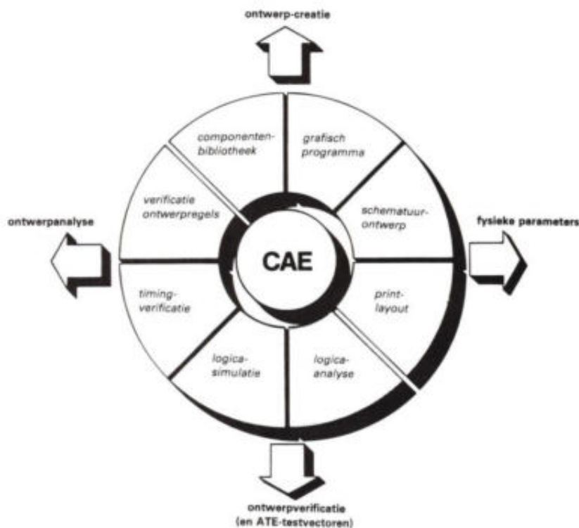
Fig. 8. Ontwerpstadia en faciliteiten bij een CAE-systeem dat is uitgebreid met logica-instrumentatie.
