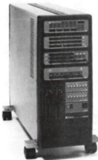
Afb. 3. De CAESAR is in feite een chassis waarin vier inschuifeenheden passen en dat is voorzien van een microcomputer en een dubbel disketteloopwerk. Het geheel is ondergebracht in een behuizing op zwenkwielen en past gemakkelijk onder een werktafel of bureau van een „CAE-landschap”.
