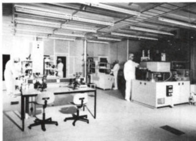
De produktieruimte van de EFFIC heeft een werkvloer van 300 m 2 en stofarme ruimte met stofklasse 100. Rechts staat een ionenimplanter en in het midden op de achtergrond enkele ovens. (Foto TH Eindhoven).
